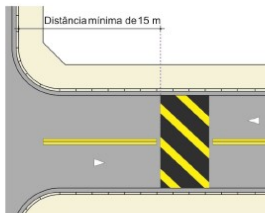
FIGURA 1: Distância mínima da lombada para a interseção
